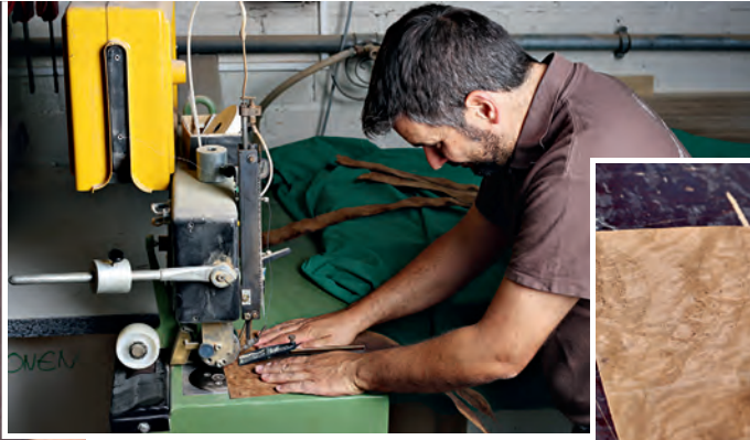
Einsatz der Zick-Zack-Furnierklebemaschine
