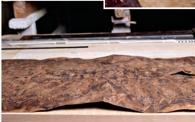
Kreuzgefügtes, noch welliges Nussbaumfurnier vor der Verpressung/Verklebung
